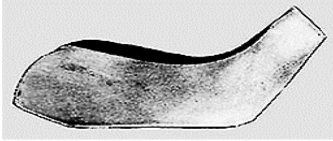
Рис. 1. Макрошлиф гребня с упрочненным слоем. Ширина упрочненной зоны 25-26 мм, максимальная глубина 1,5- 2,7 мм. Высота гребня 28 мм.
