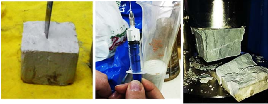
Рис. 1. а) шлаковый камень при комнатной температуре, через 24 часа; б) водоотделение шлакового раствора после 30 мин после затворения; в) шлаковый камень после испытания на сжатие
