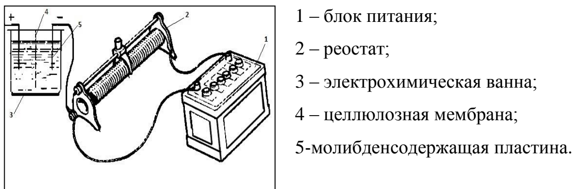
Рис. 2. Схема электрохимического способа переработки молибденосодержащих отходов
