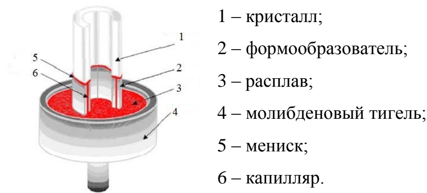
Рис. 1. Схема установки для выращивания кристаллов лейкосапфира (метод Степанова) [2; 4]
