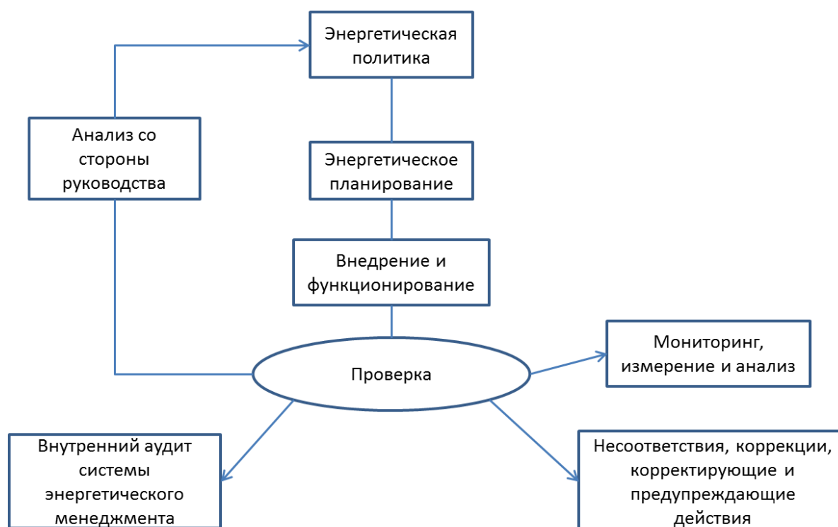
Рис. 1. Структура СЭМ согласно ГОСТ Р ИСО 50001–2012.
