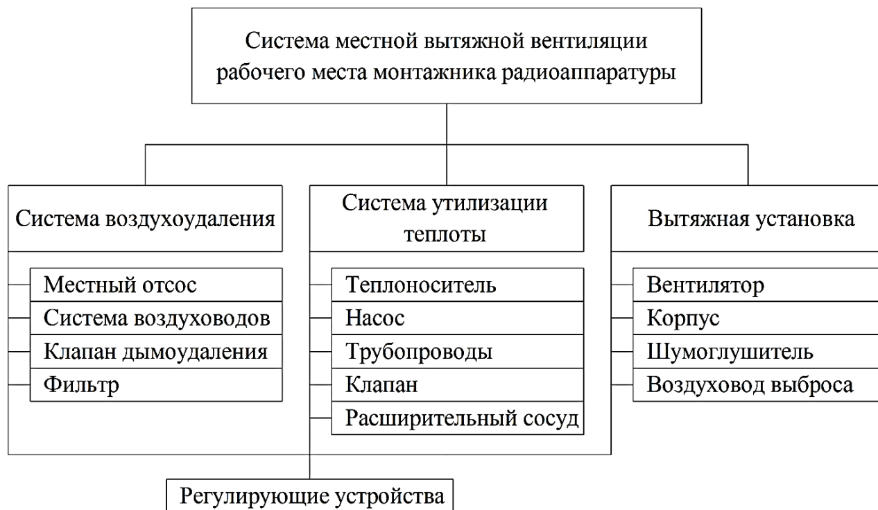
Рис. 1. Структурная модель системы местной вытяжной вентиляции
