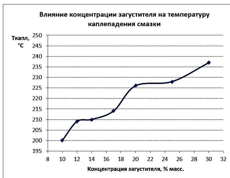
Рис. 1. Влияние концентрации загустителя на температуру каплепадения смазки
