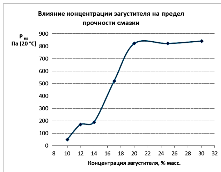
Рис. 2. Влияние концентрации загустителя на предел прочности смазки
