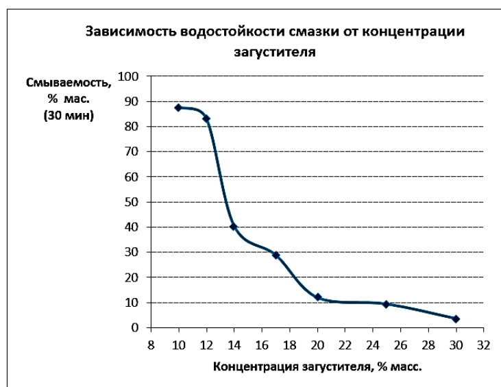
Рис. 4. Зависимость водостойкости смазки от концентрации загустителя
