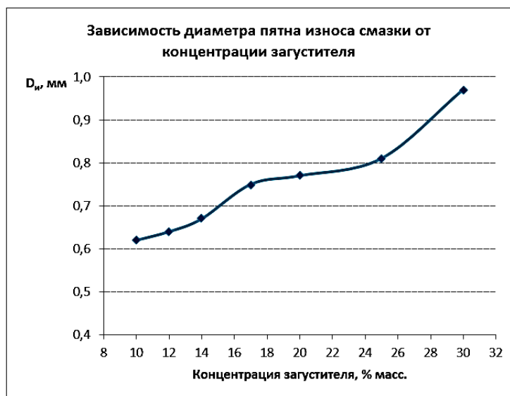
Рис. 3. Влияние концентрации загустителя на диаметр пятна износа смазки
