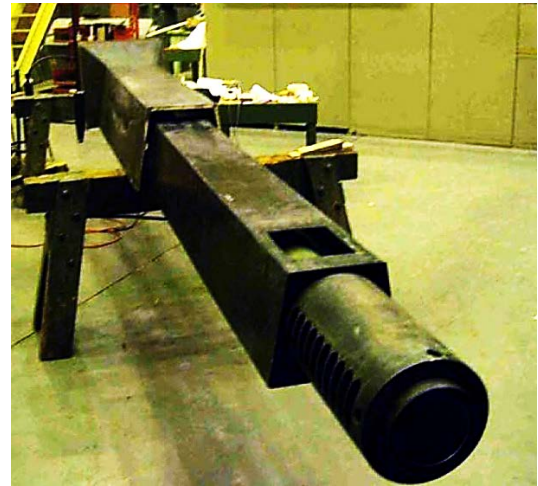
Рис. 5. Кожух, установленный на стволе
