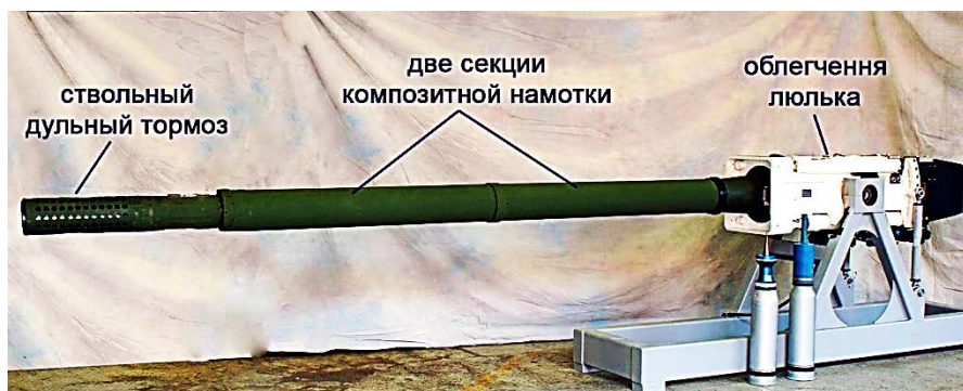
Рис. 1. Новая 120-мм пушка XM360 для танка MCS
