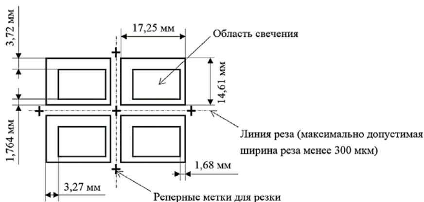
Рис. 2. Схематическое изображение кристаллов с размерами, имеющими значение при ЛУТ
