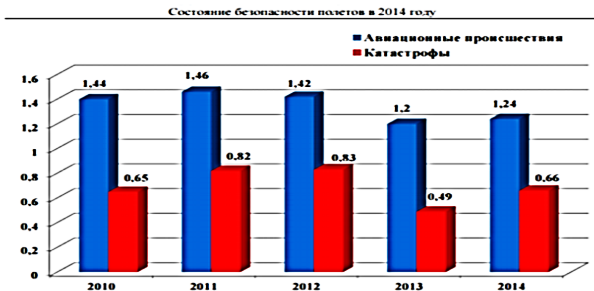
Рис. 1. Количество авиационных происшествий и катастроф на 100 тыс. часов полета на всех воздушных судах в гражданской авиации государств-участников Соглашения, включая АОН
