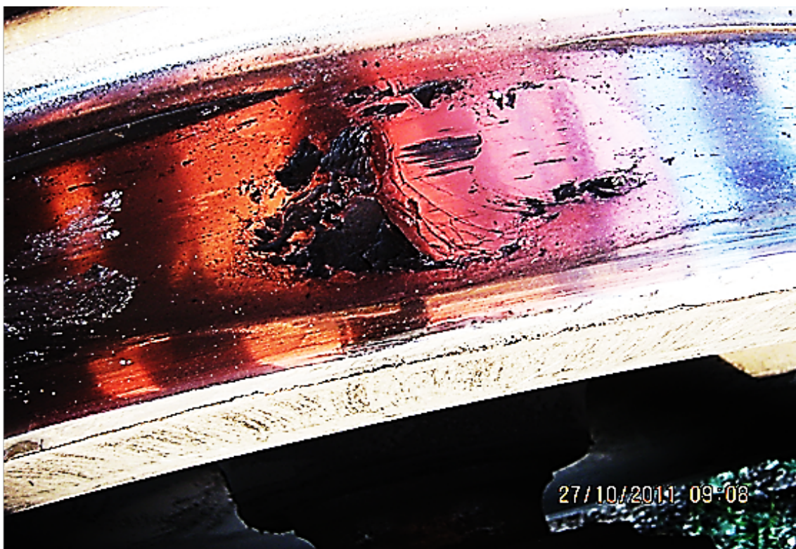
Рис. 3. Дефекты на поверхности катания колесной пары
