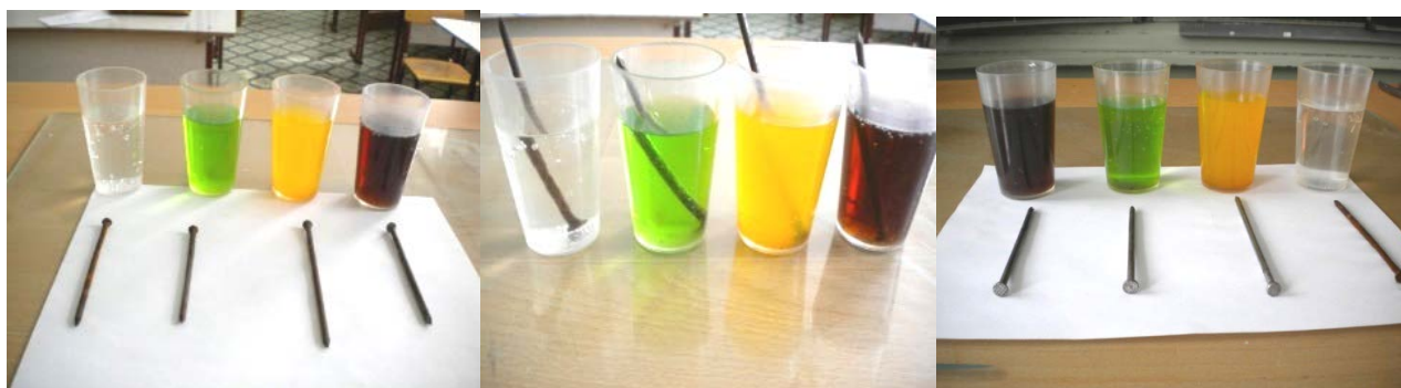
Рис. 3. Влияние кислой среды газированных напитков на ржавчину: слева – начало опыта, посередине – через 1 час, справа – через 24 часа
