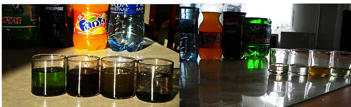
Рис. 1. Определение красителей в газированных напитках: слева напитки до адсорбции красителей активированным углем, справа после
