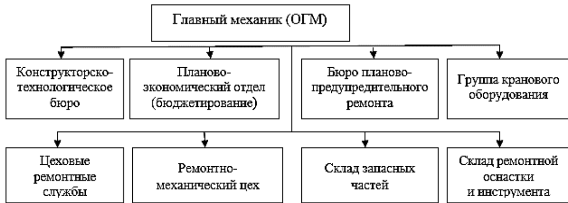
Рисунок 1. Модуль управления ремонтной службой хозяйствующего субъекта
