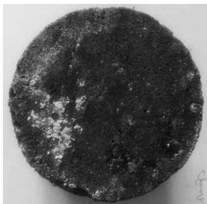
Рис. 3. Внешний вид образцов состава с микрокремнеземом МК-85 и без пластификатора после ускоренного испытания на высолообразование
