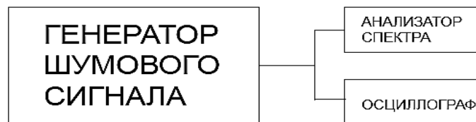
Рис. 5. Схема подключения приборов для анализа выходного сигнала
