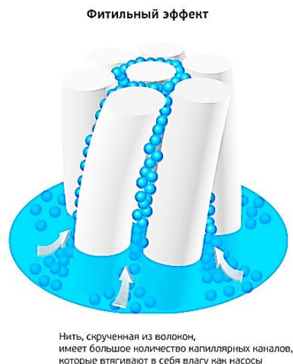
Рис. 2. Схематичное изображение принципа работы гидрофильных тканей
