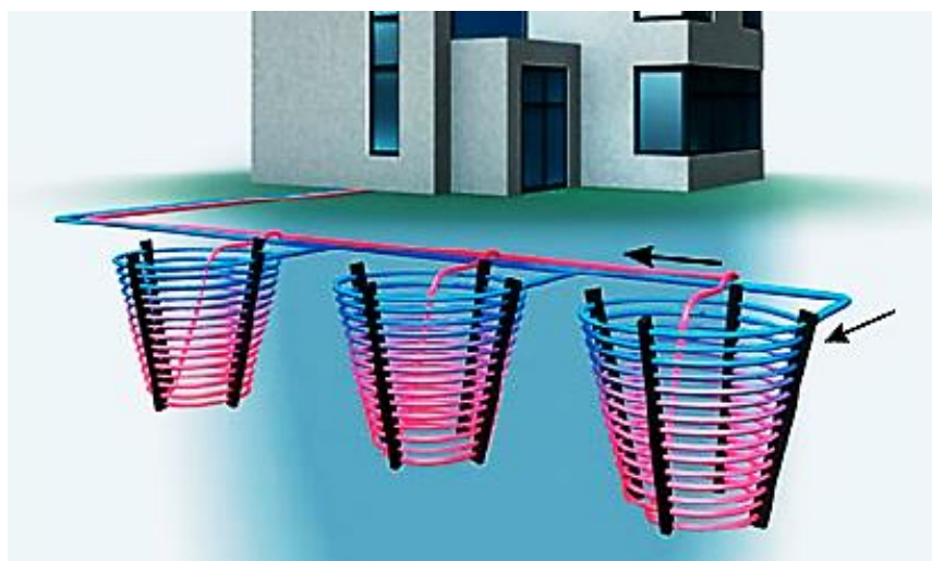
Рис. 3. Геотермальный теплообменник типа «Корзина»
