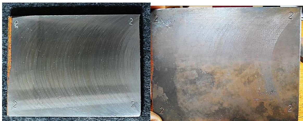
Рис. 3. Образец с покрытием на основе силиконовой аэрозольной смазки
