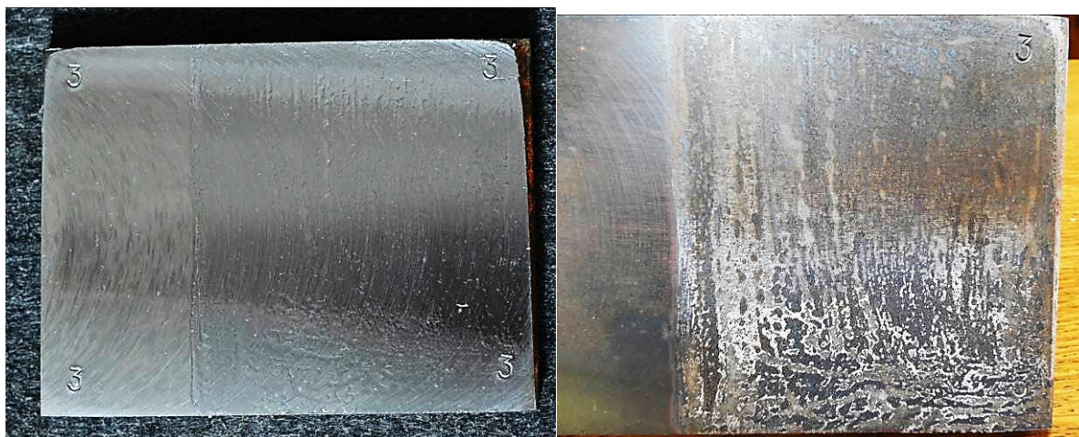
Рис. 4. Образец с защитным покрытием на основе жидкого натриевого стекла
