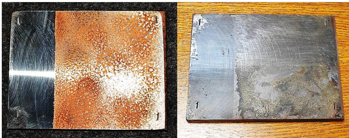
Рис. 2. Образец с защитным покрытием на основе медьсодержащего аэрозольного спрея
