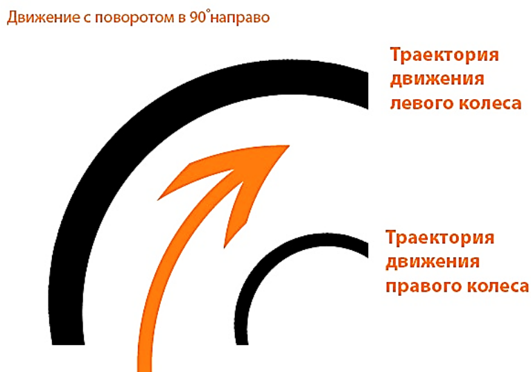
Рис. 1. Траектории движения колес при повороте
