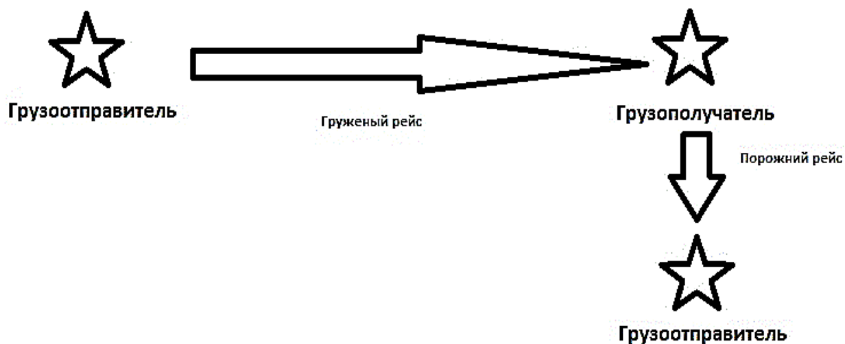
Рис. 2. Оборот вагона-цистерны с поиском ближайшего отправителя
