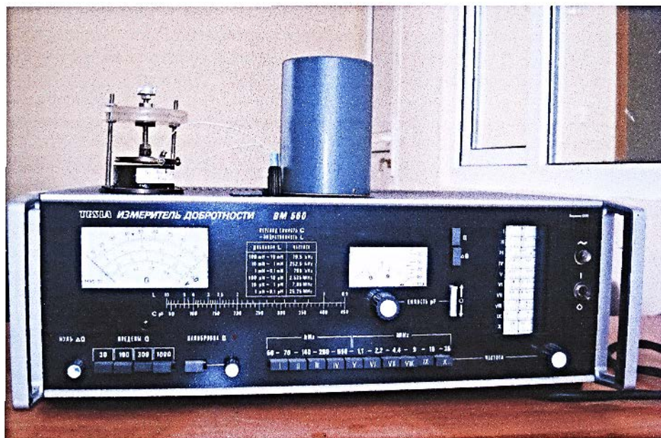
Рис. 1. Общий вид прибора «Измеритель добротности» BM – 560
