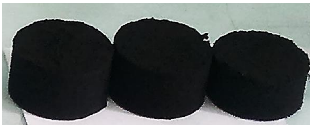
Рис. 4. Брикеты, полученные со связующим из муки чертополоха
