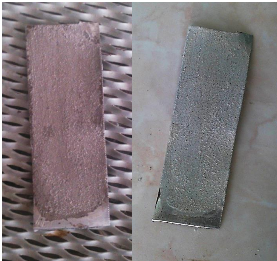
Рис. 3. Металлическая деталь, покрытая краской при комнатной температуре (а), и после отжига при 873 К в течение 30 мин (б)
