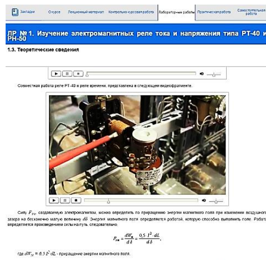
Рис. 6. Совместная работа реле РТ-40 и реле времени
