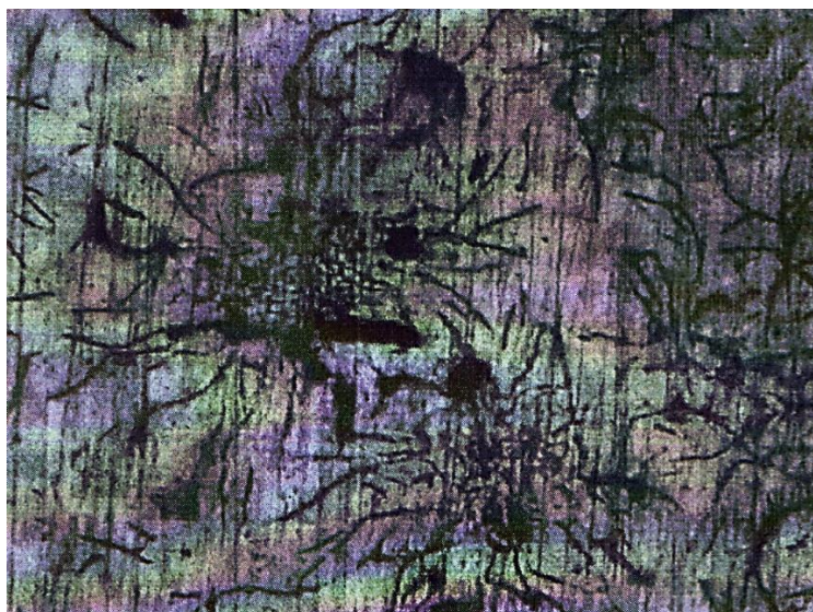
Рис. 4. Микроструктура радиатора. Серый чугун с перлитно-феррито-графитной микроструктурой. Увел. 500х
