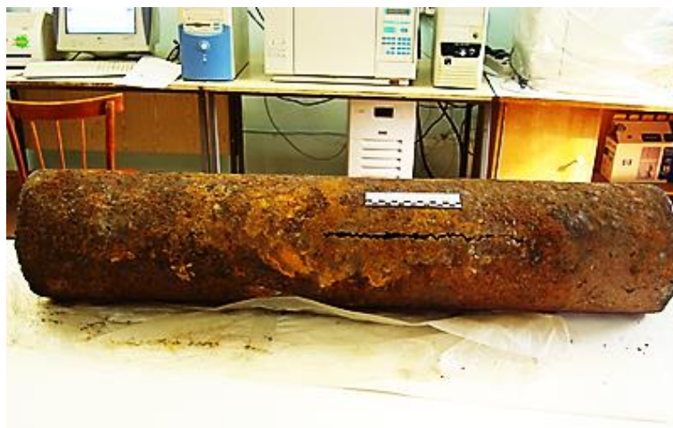
Рис 1. Фрагмент трубы с трещиной, представленный на исследование
