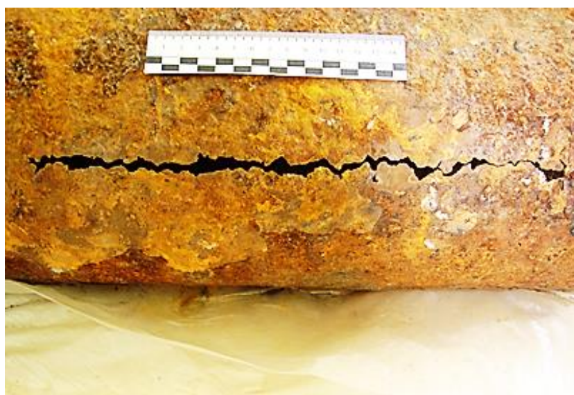
Рис. 2. Путь распространения трещины на трубе, представленной на исследование
