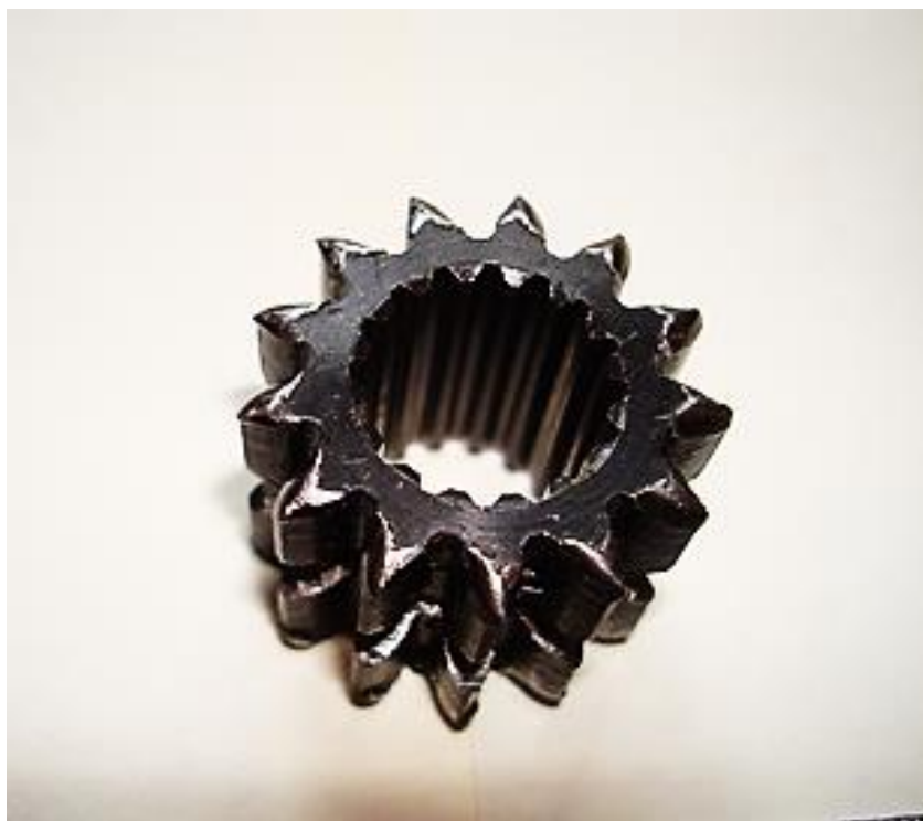
Рис. 7. Смятие и износ зубьев шестерни переключения хода редуктора мотокультиватора «Крот»
