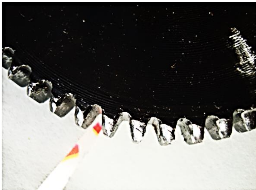
Рис. 3. Сильное смятие, наплыв материала шестерни со стороны звездочки
