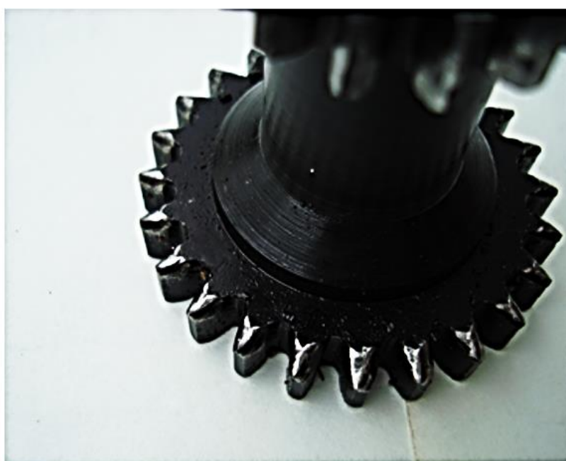
Рис. 5. Износ и смятие зубьев большой сдвоенной шестерни
