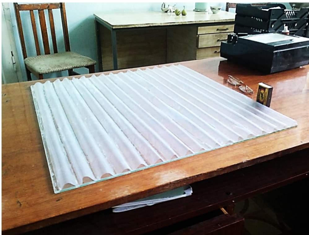
Рис. 2. Общий вид модуля двухслойного прозрачного покрытия
