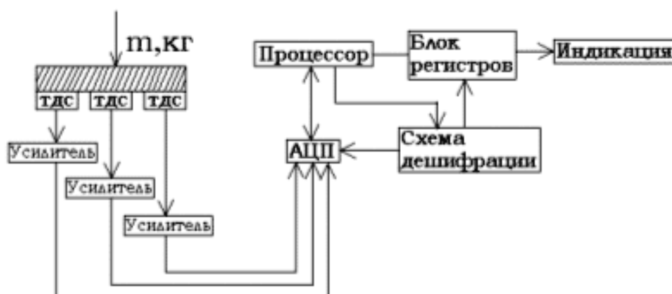
Рис. 5. Структурная схема устройства измерения веса на основе тензометрических датчиков
