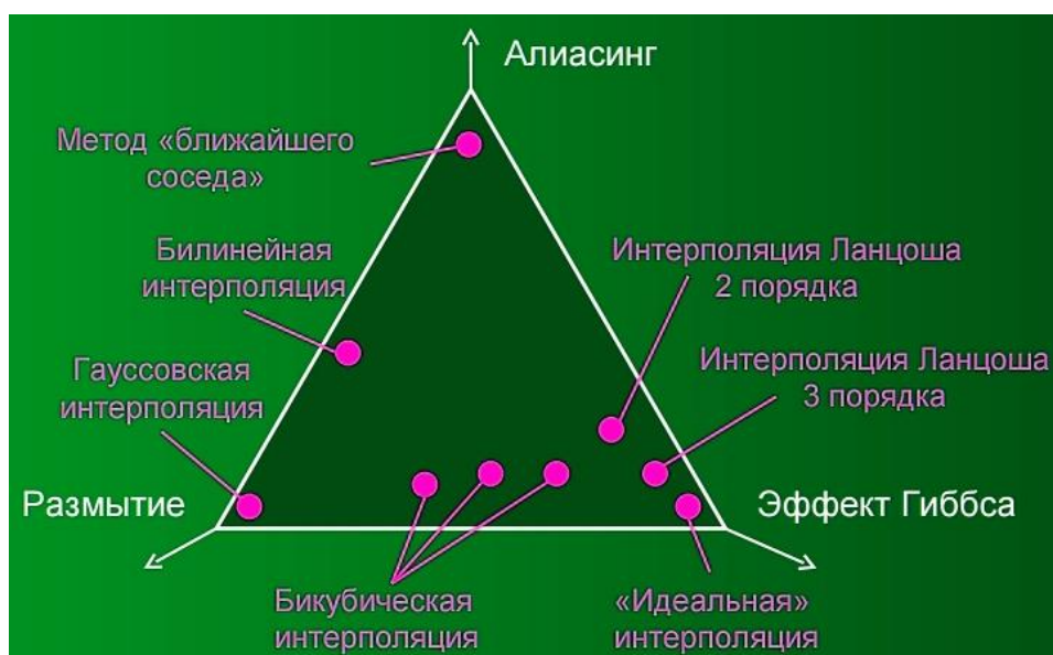
Рис. 5. Структурная схема «баланса» артефактов, для каждого из линейных методов интерполяции
