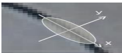
Рис. 6. Пример различного распределения ядра K вдоль и поперек границ
