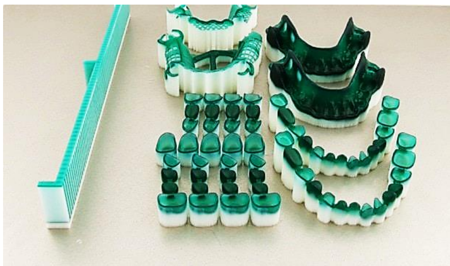
Рис. 2. Формы для отливки зубов, напечатанные 3D принтером
