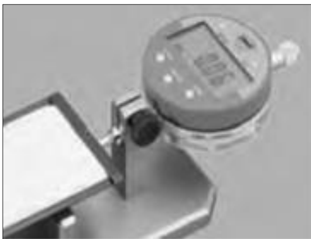
Рис. 7. КоЕх – устройство для измерения расширения и сжатия различных материалов
