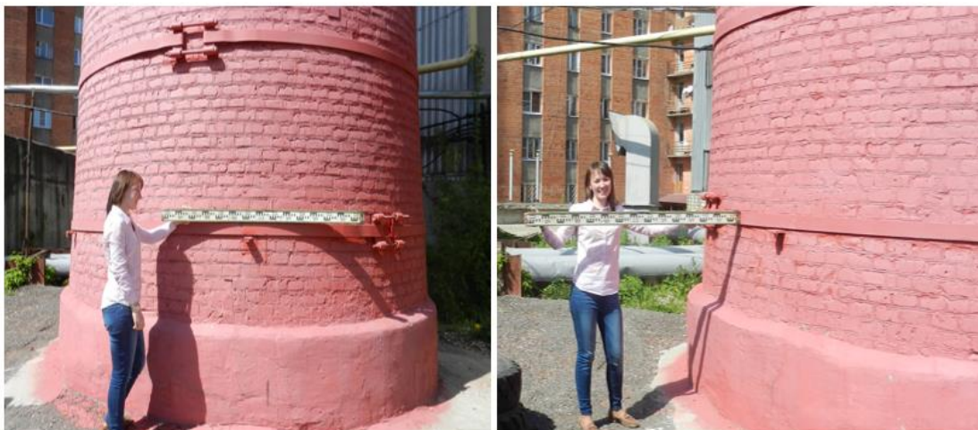
Рис. 11. Фотографирование базиса для определения d_1 , \Delta_{1-2} и d_2
