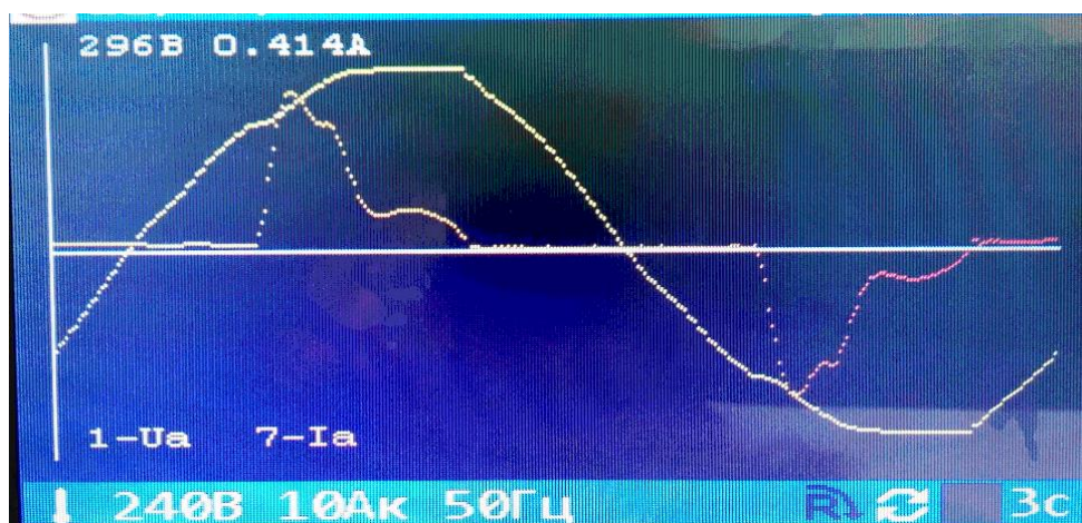
Рис. 4. Графики тока и напряжения в цепи с тремя светодиодными лампами
