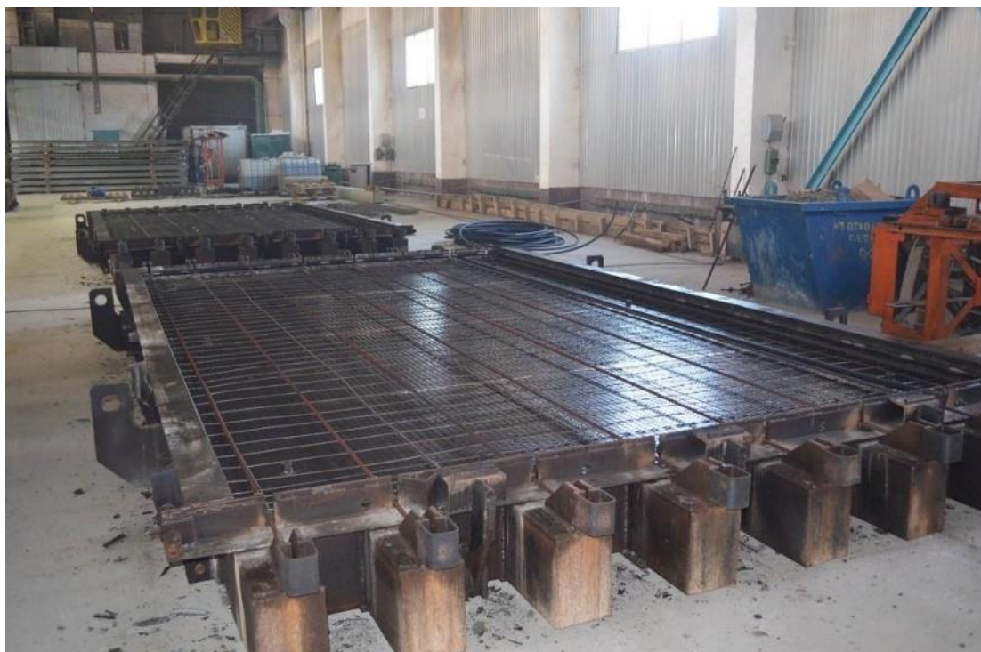
Рис. 2. Производственный цех по производству дорожных плит
