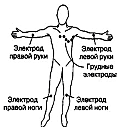
Рис. 6. Расположение электродов на теле пациента
