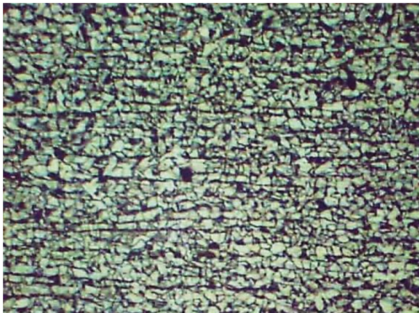
Рис. 4. Микроструктура низколегированной стали 09Г2С. Основной металл. Увел.500
