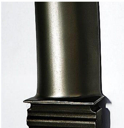
Рис. 1. Поверхность турбинной лопатки после обработки методам ГАО в стационарной установке
