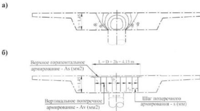
Рис. 7.7. Зоны местных напряжений (а) и расположение верхней горизонтальной и вертикальной поперечной арматуры (б) в месте опирания пролетного строения
