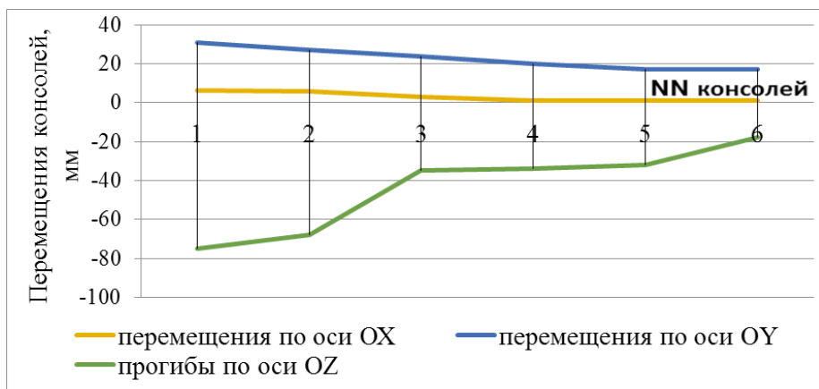
Рис. 4.25. Перемещения консолей различных форм поперечного сечения
