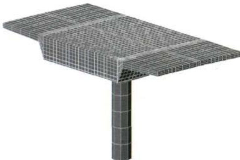
Рис. 7.2. Расчетная конечно-элементная модель надпорной зоны пролетного плитного строения
