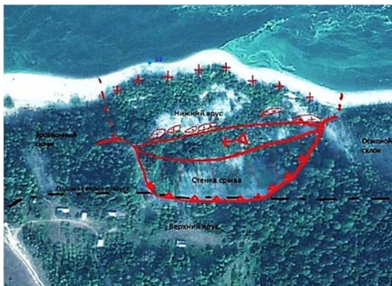
Рис. 4. Снимок оползня «Утёс» со спутника и элементы оползня (карта Google map)
