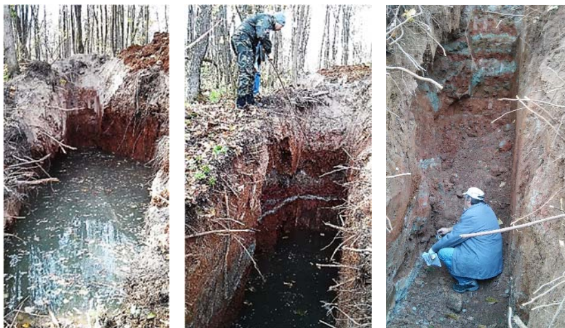
Рис. 3. Уровень подземных вод в исследуемых шурфах 1) верхний шурф 2) средний шурф 3) нижний шурф
