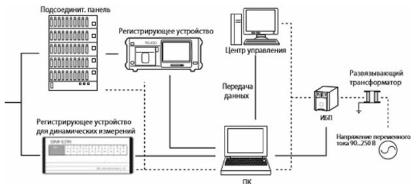
Рис. 7. Схема подключения аппаратного оборудования
