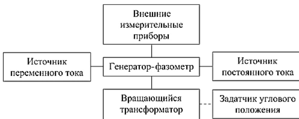
Рис. 2. Структурная схема лабораторного стенда «Исследование вращающихся трансформаторов»
