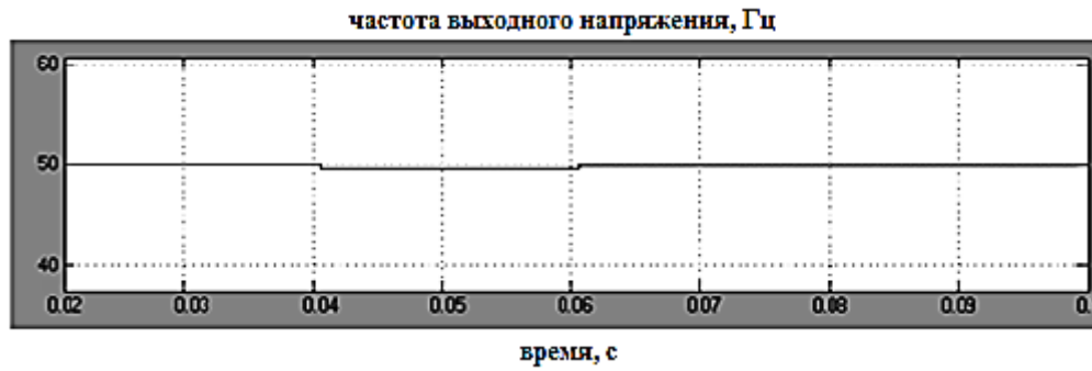
Рис. 5. График частоты выходного напряжения микроГЭС при использовании RC-фильтра
