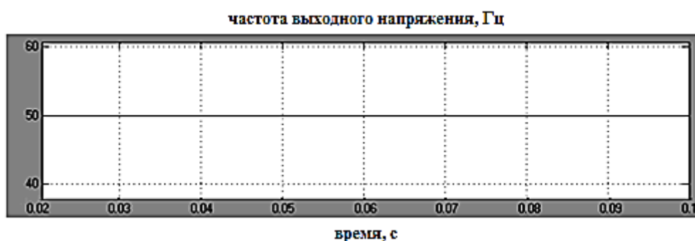
Рис. 2. График частоты выходного напряжения микроГЭС
