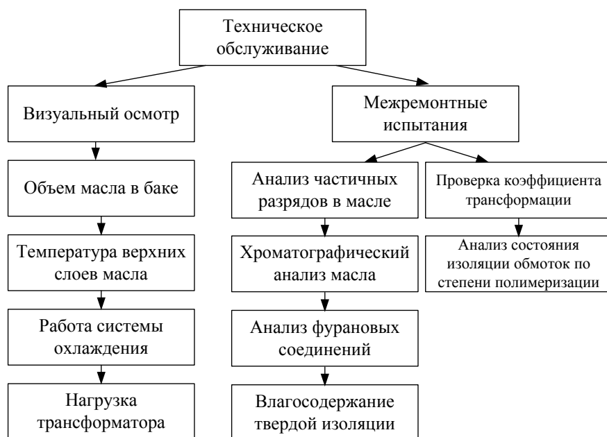
Рис. 1. Схема операций ТО силовых трансформаторов
