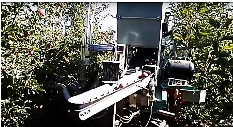
Рис. 2. Прототип плодуборочной машины, разработанной FFRobotics
