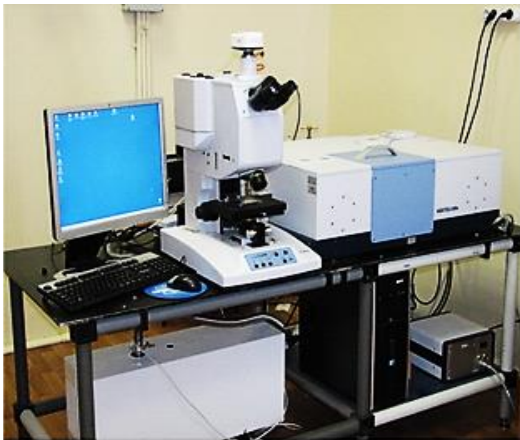
Рис. 4. ИК-спектрометр «Vertex80v», г. Черноголовка
