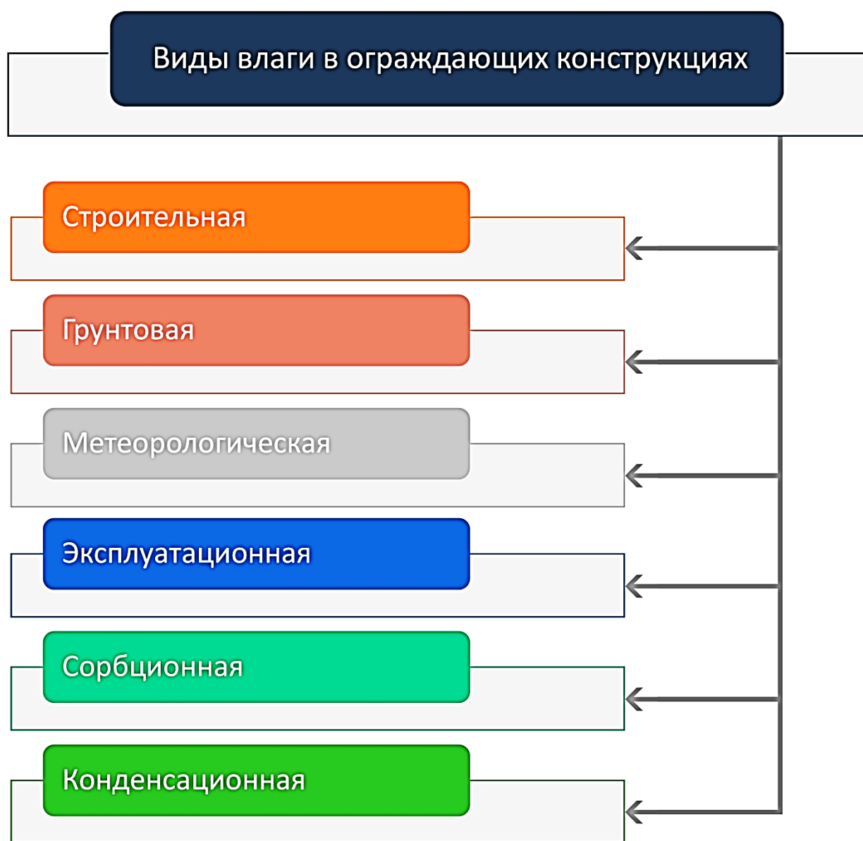
Рис. 1. Виды влаги в строительных ограждающих конструкциях
