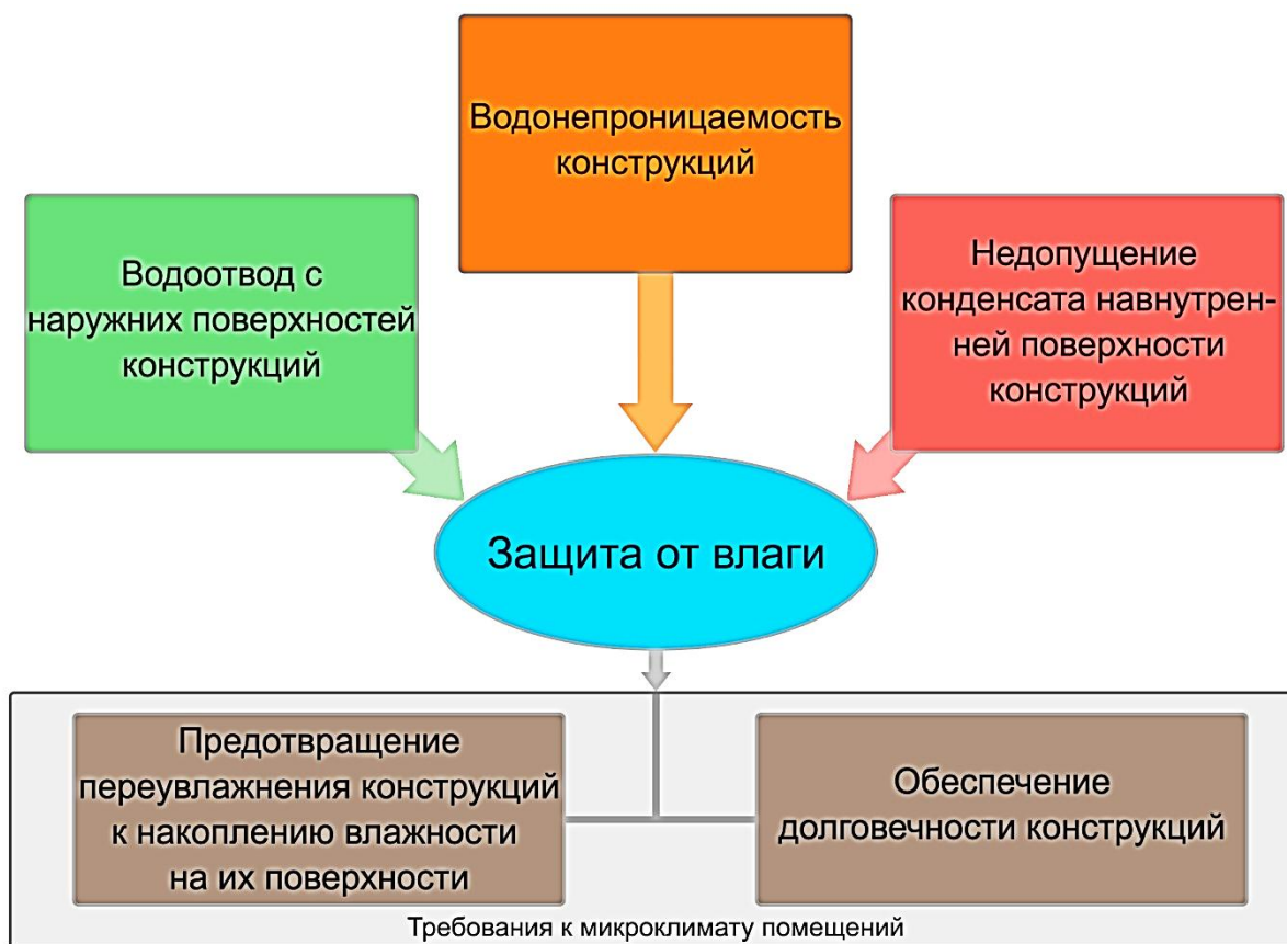
Рис. 2. Требования к обеспечению защиты от влаги ограждающих конструкций (с учетом требований к микроклимату помещения)
