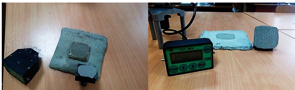
Рис. 2. Испытания адгезионной прочности полимерцементного композита (а) и контрольного песчано-цементного образца (б)
