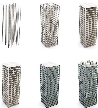
Рис. 2. Трёхмерная модель каркаса многоэтажного деревянного дома
