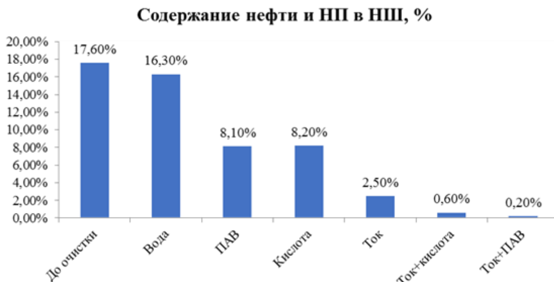
Рис. 1. Содержание нефти и нефтепродуктов до и после очищения нефтешламов
