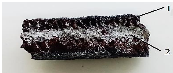
Рис. 2. Вид образца после пропитки на сколе
