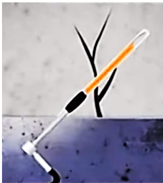
Рис. 1. Технология инъектирования трещины
